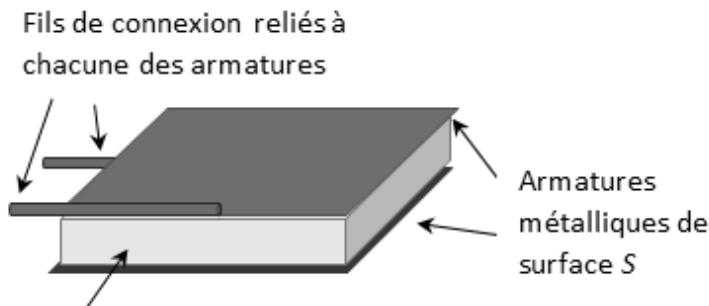
Isolant d'épaisseur  $a$  La capacité du condensateur plan est donnée par la relation :
