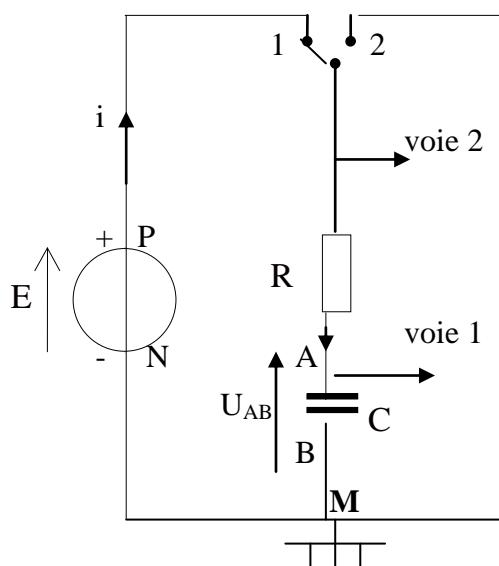
On veut visualiser les variations de la tension  $u_{AB}$  aux bornes du condensateur lors de la charge et lors de la décharge et aux bornes du générateur.
