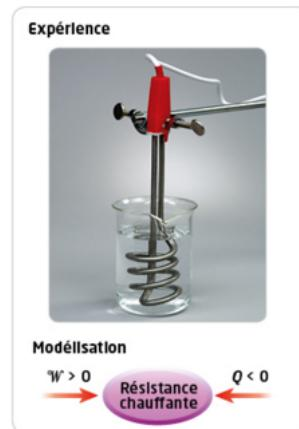
Résistance chauffant de l'eau. Le travail électrique  $W$  est positif pour la résistance chauffante. Le transfert thermique  $Q$  est négatif pour la résistance chauffante et positif pour l'eau. On parle de « convention porte-monnaie ».
