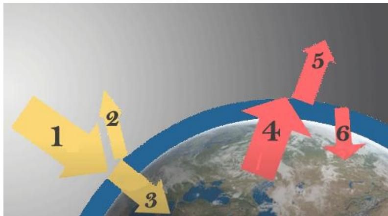
**1 :** Une partie du flux thermique émis par le soleil est reçu par la terre. Il sera noté  $\varphi_{S-reçu/T}$
