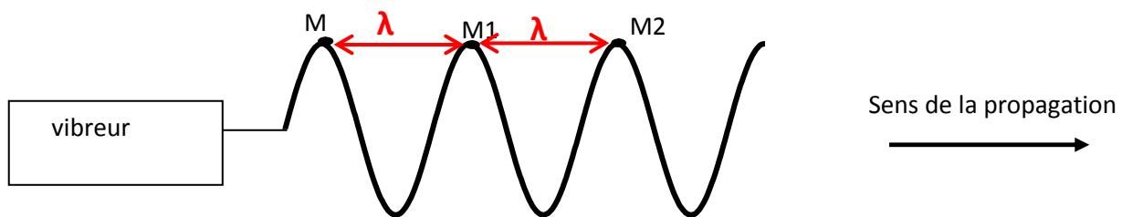
Le vibreur crée des perturbations de forme sinusoïdales à intervalles de temps constant.
