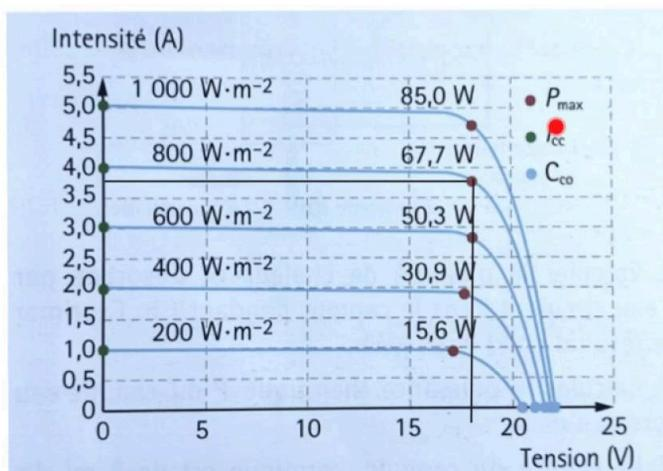
Caractéristique courant tension puissance d'une cellule
