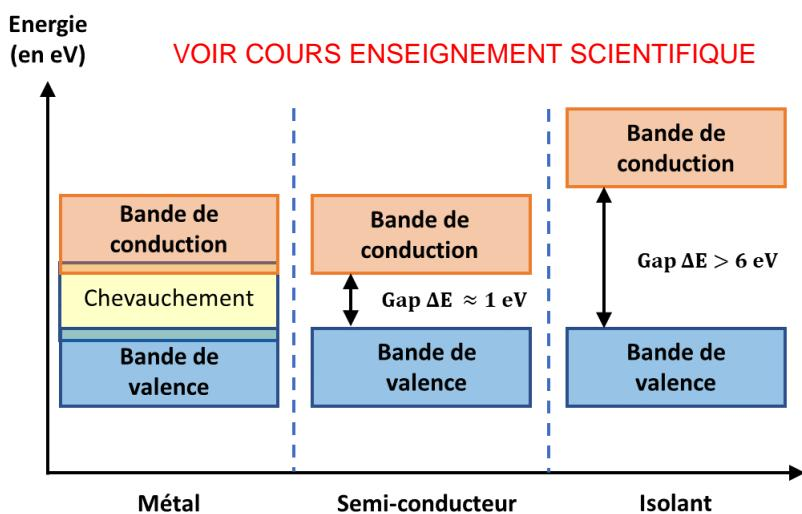
– Diagramme illustrant la différence entre les niveaux d'énergie pour un métal, un semi-conducteur et un isolant.
