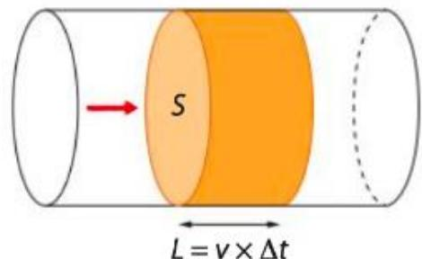
Le volume de fluide s'écoulant pendant  $\Delta t$  est :
