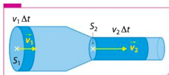
Application : Le jet d'eau d'un tuyau que l'on rétrécit pour qu'il aille plus loin.
