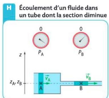
Dans une conduite horizontale possédant un étranglement en B, une dépression est observée au niveau de l'étranglement ( $P_B < P_A$ ).
