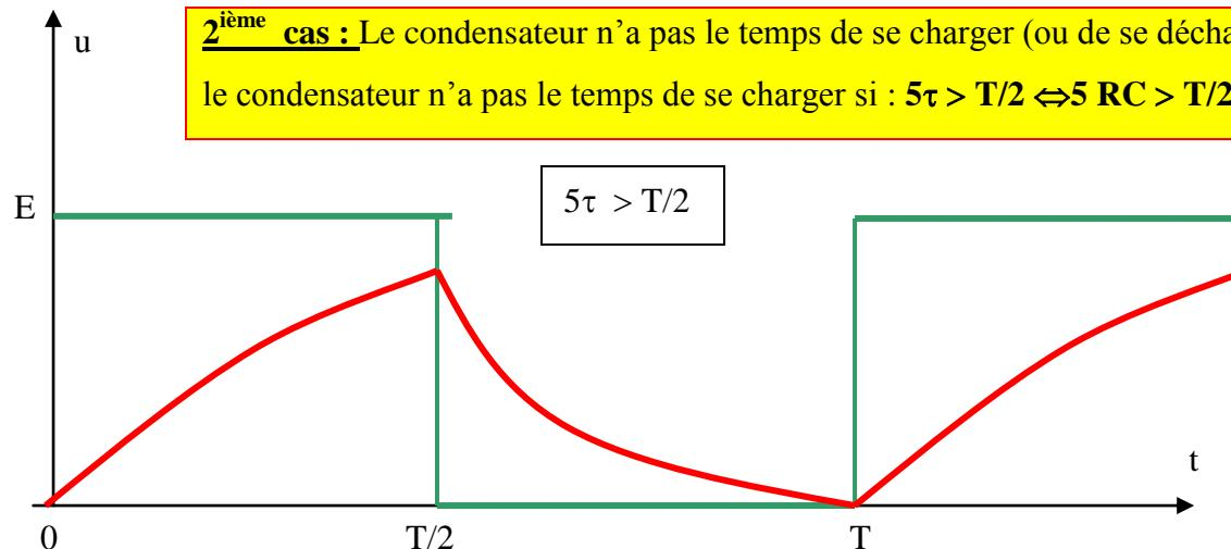
Le phénomène de charge et décharge du condensateur étant périodique, on peut visualiser ce phénomène à l'aide d'un oscilloscope simple.
