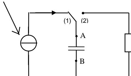
On relie les bornes du condensateur, initialement déchargé, à l'interface d'un ordinateur et on fait une acquisition afin d'obtenir la courbe  $u_{AB} = f(t)$ .
